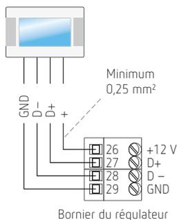
Si un câble à 2 fils est disponible entre la chaufferie et l'endroit de montage du panneau de contrôle, il est possible d'utiliser une alimentation séparée pour le panneau de contrôle.
