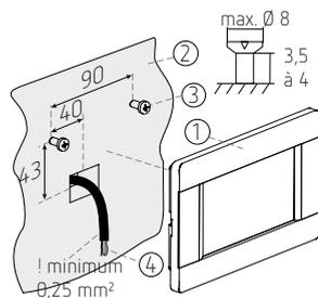
Connectez le câble à 4 fils au régulateur selon le schéma page 25. Dans les installations où seulement un câble à 2 fils est disponible, il est possible de raccorder le panneau au régulateur à condition de prévoir une alimentation 5 V DC supplémentaire, page 25.
