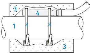
Les sondes sont prévues pour un montage dans un doigt de gant mais une fixation sur le tuyau après avoir découpé celui-ci est possible. Dans ce cas, utilisez une pâte de contact thermique et un collier de fixation approprié (si un colson en plastic est utilisé, il faut utiliser un matériau qui résiste à des températures pouvant atteindre 80 °C, voire plus).
