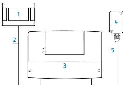
Le régulateur se compose principalement d'un panneau de contrôle avec écran tactile (ou touch panel) (1) et d'un module de commande (3). Ces 2 composants sont connectés l'un à l'autre à l'aide d'un câble à 4 fils (2). Pour le bon fonctionnement du système, une sonde pour la mesure de la température extérieure est indispensable (4) et est connectée au module de commande (3) à l'aide d'un simple câble à 2 fils (5).
