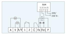
Ce schéma ne convient pas pour les thermostats ne disposant pas d'un contact libre de potentiel
