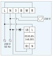
Ce schéma ne peut être utilisé que pour commander un brûleur qui n'est pas alimenté séparément (le contact R-B n'est pas libre de potentiel si la borne R est pontée avec la phase L).
