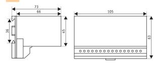
Le SAM 91 est prévu pour un montage dans un coffret électrique pour appareils modulaires. Cependant, il est possible de le monter dans un tableau électrique ou sur la chaudière.
