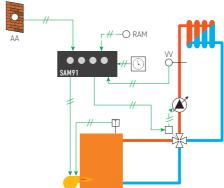
AA = sonde extérieure, VV = sonde de départ, T = thermostat de chaudière, 🛱 = mélangeur, M = servomoteur, 🌢 = circulateur. 🛣 = flow-valve, 0530.85.148.001 (INRH) = relais temporisé au déclenchement pour circulateur
